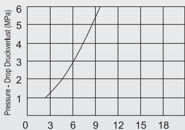
Flow - Durchfluss - L/min (Oil-Oil t=50°C) 30c5
